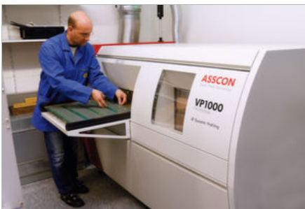
Dampfphase Asscon VP1000 ( Peter Storm, ATP Elektronik GmbH)
